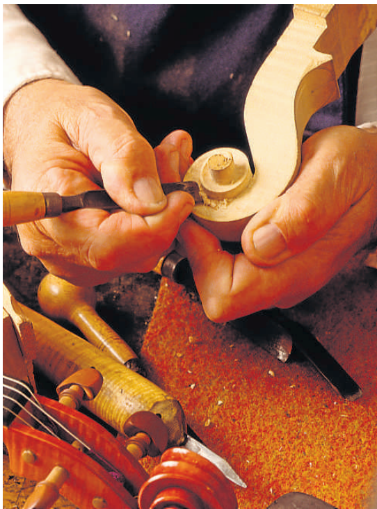
Les mans d'un lutier rebaixant la fusta per donar forma a un nou violí JOHN TERENCE TURNER / GETTY
