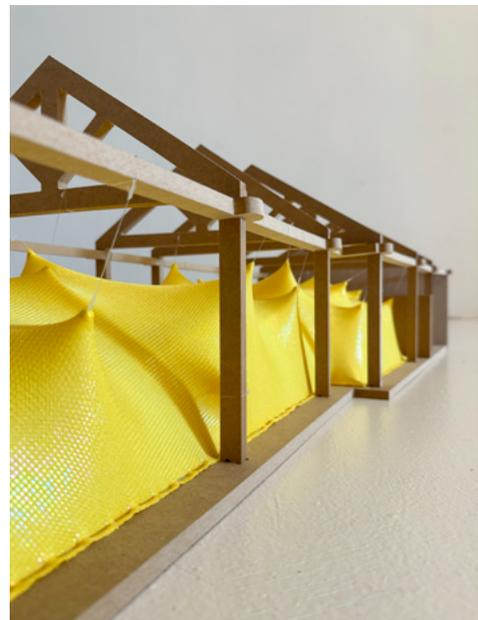
Maqueta de la estructura tensada.
